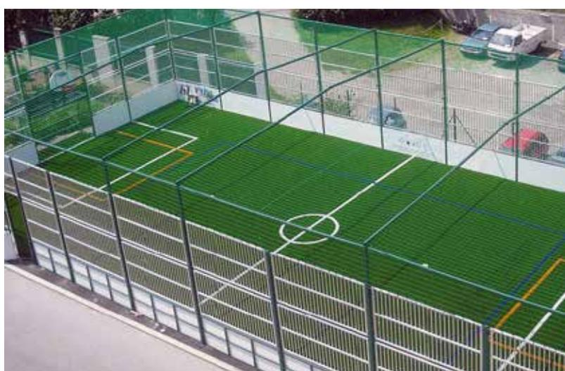
*Der neue Funcourt bei der Mittelschule wird 25 \* 15 Meter groß sein, das ist etwa gleich groß wie die Bodenfläche des Turnsaals. Er wird aus Aluminium gebaut und einen Kunstrasenboden der neuesten Generation ohne umweltschädliche Plastikpartikel haben.*
